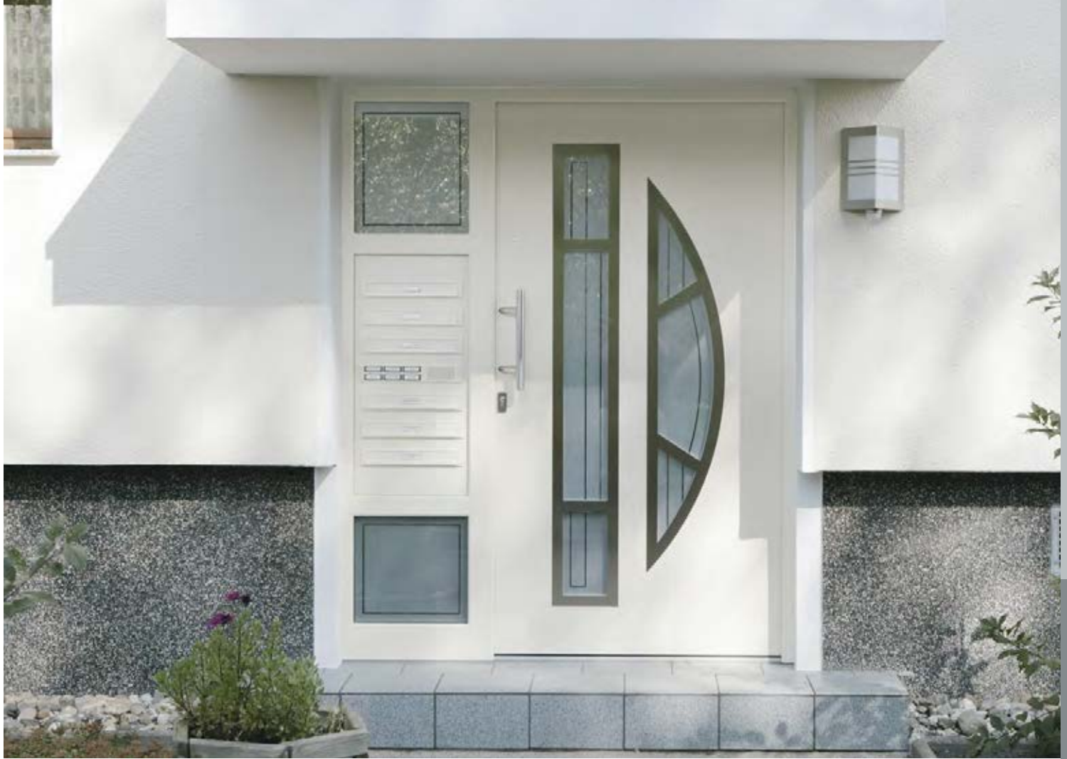
LA 480 E Farbe: RAL 1015 hellelfenbein mit 40 mm Edelstahlrahmen flächenbündig Glastyp: 480.7225 Klarglas teilmattiert Linien klar Griff: M 8022 Seitenteilverglasung: Klarglas teilmattiert Linien klar Preisgruppe 10 Seitenteilfüllung: mit Briefkästen, Klingeln und Sprechanlage
