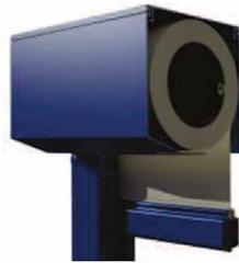
Aus stranggepresstem Aluminium gefertigter, geschlossener Kasten mit pulverbeschichteter und einbrennlackierter Oberfläche, inkl. Druckgussblendenkappen und 63/78 oder 100 mm Nutwelle mit teleskopierbarer Walzenkapsel und entsprechender Kastengröße.
